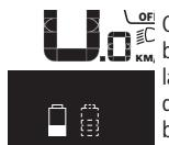
**U.0** km Om båda batterier på en eBike med två batterier laddas på cykeln så visas laddningen för båda batterier på displayen (på bilden laddas det vänstra batteriet). Vilket av de båda batterierna som laddas ser du på den blinkande indikatorn på batteriet.
