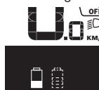
Se numa eBike com duas baterias colocadas forem carregadas ambas as baterias na bicicleta, então no mostrador é exibido o progresso de carregamento de ambas as baterias (na imagem está a ser carregada de momento a bateria esquerda). Qual das baterias está a ser carregada também é reconhecível na indicação a piscar na bateria.
