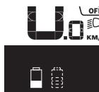
Werden an einem eBike mit zwei eingesetzten Akkus beide Akkus am Fahrrad geladen, so wird auf dem Display der Ladefortschritt der beiden Akkus angezeigt (in der Abbildung wird gerade der linke Akku geladen). Welcher der beiden Akkus gerade geladen wird, können Sie auch an der blinkenden Anzeige am Akku erkennen.
