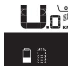
Se in una eBike con due batterie inserite verranno caricate entrambe le batterie, sul display verrà visualizzato l'avanzamento della carica per entrambe le batterie (nella figura, la batteria in fase di carica è quella sinistra). L'indicazione lampeggiante sulla batteria indicherà anche quale delle due batterie si trovi al momento in fase di carica.
